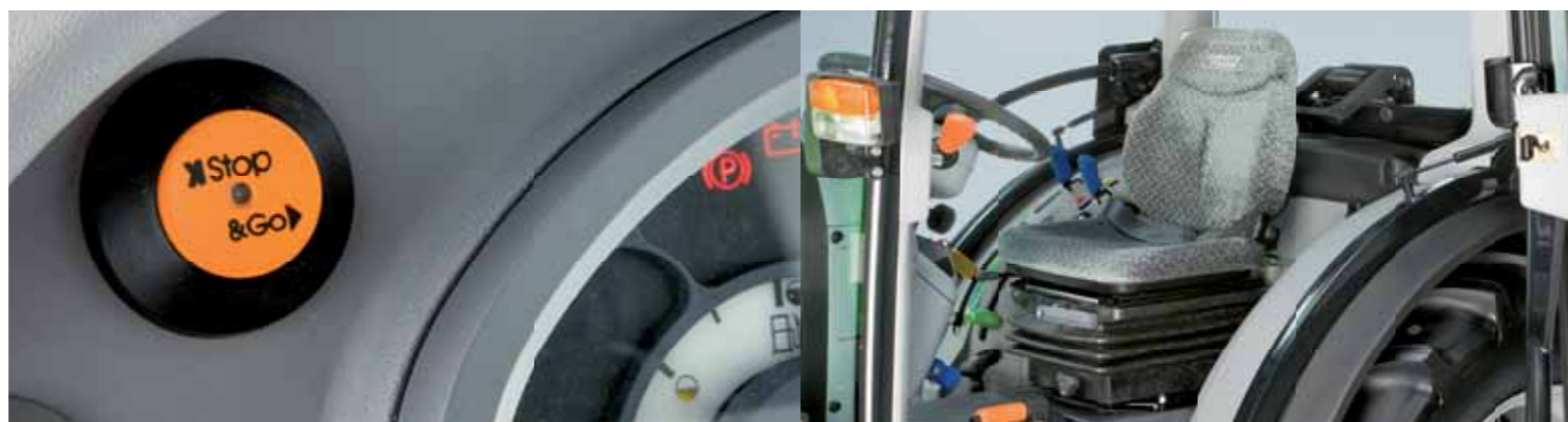
Systém Stop&Go se aktivuje stiskem tlačítka.
