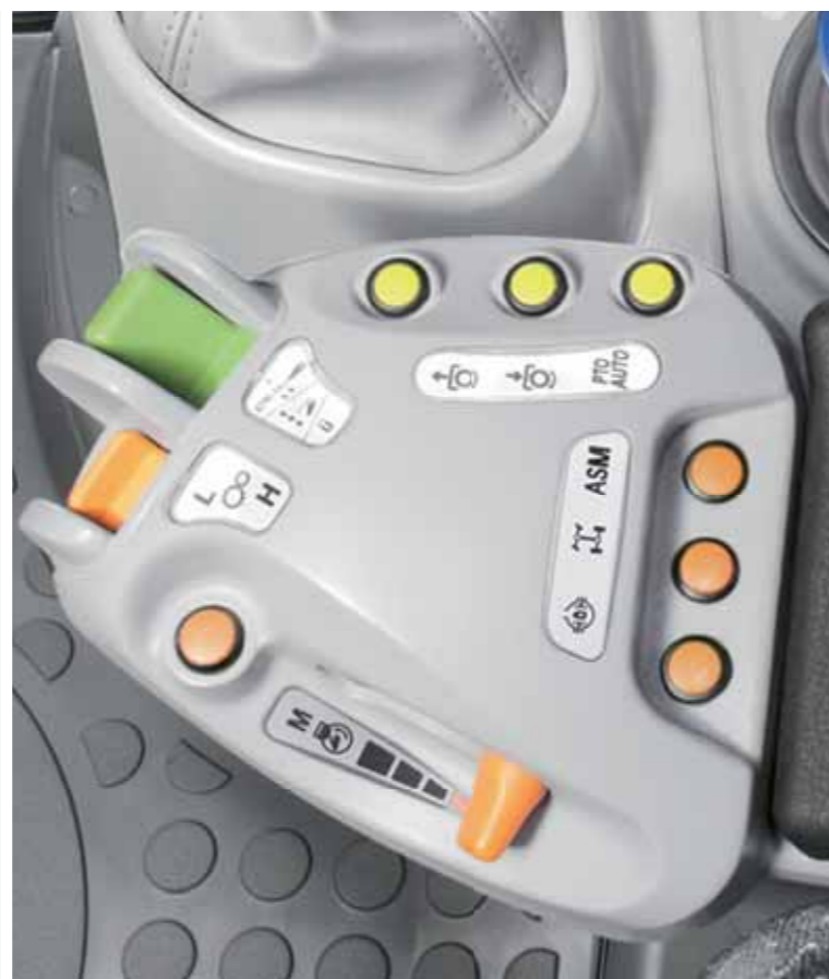
Multifunkční opěrka s ergonomickým uspořádáním všech funkcí je standardem pro všechny modely a výbavové verze (kromě ProfiLine).
