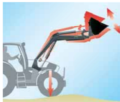
Jízda se systémem ComfortDrive: kmitání je eliminováno. Traktor, nakladač ani řidič nejsou zbytečně namáháni.
