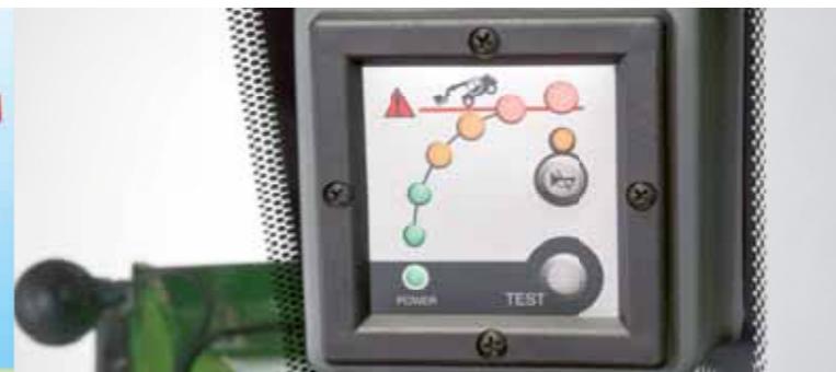
Elektronický ukazatel přetížení ramene varuje pomocí optického i akustického signálu před převážením.
