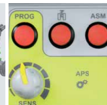
Nastavení rychlosti reakce automatického powershiftu.
