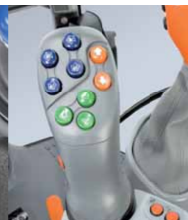
Veškeré funkce po ruce na PowerComS páce (pouze ProfiLine).
