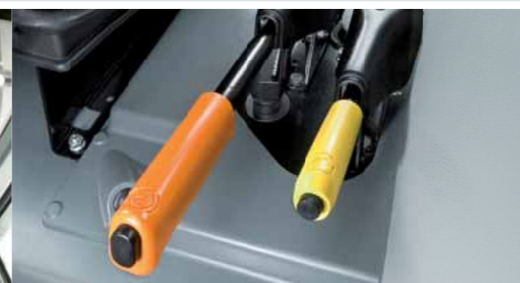
Vývodová hřídel se spouští mechanicky pomocí pák na levé straně kabiny.
