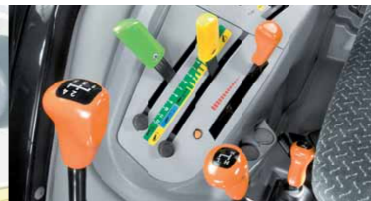
Agropus Ecoline modely disponují plnohodnotnou 5-stupňovou mechanickou převodovkou se synchronizací a suchou lamelovou spojkou.
