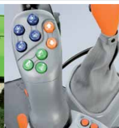
PowerComS páka slouží i ke změně jednotlivých stupňů pod zatížením.
