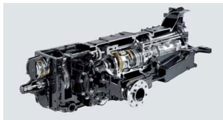
Nová plynulá převodovka Agrofarmu TTV – velmi úzká a kompaktní konstrukce vhodná právě pro nasazení v kompaktní třídě traktorů.
