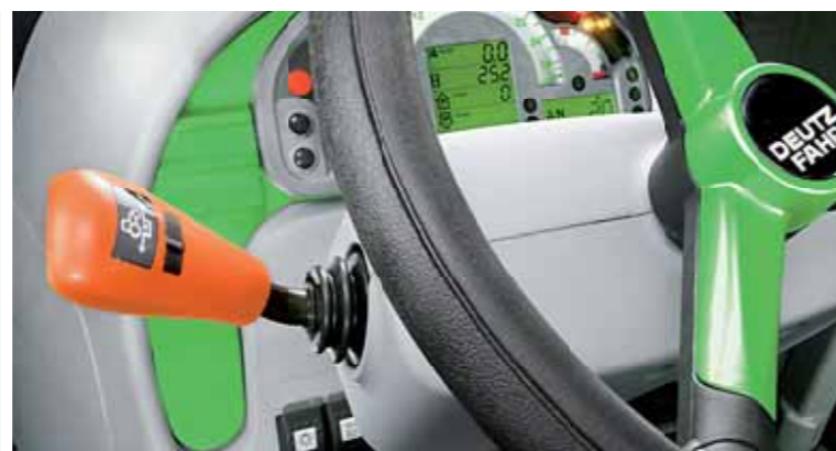
Elektrohydraulická reverzace s pěti stupni volby rychlosti reakce změny směru jízdy ještě více zvyšují komfort.
