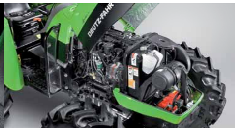
Kabelové svazky a veškeré další díly jsou optimálně uchyceny pod jednodílnou kapotou a tak optimálně chráněny.
