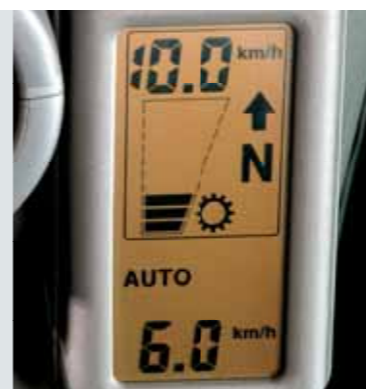
Vše potřebné na jednom místě – monitor převodovky.
