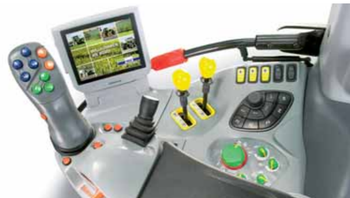
Řidič má všechny důležité ovladače v dosahu rukou. Ruka je při ovládání opřená o loketní opěrku – chybné povely jsou tak vyloučeny.
